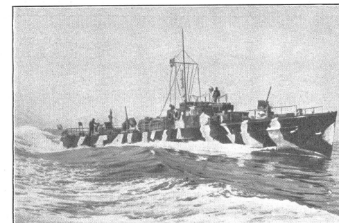
Bild 7: Modernes deutsches Minenräumboot Typ R 17, ein Motorboot von 90 t Wasserverdrängung, 18 Knoten Geschwindigkeit, 2 Flab-Geschützen 20 mm und ganz geringem Tiefgang.
