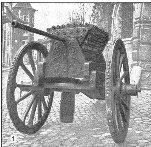
Fig. 1 e 2. Cannone ad organo di 39 canne del 16.º secolo, d'origine solettese. La canna centrale che serve d'asse girevole per il blocco di canne è costruita a retrocarica con culatta a cuneo. Le altre 38 canne sono ad avancarica. (Collezione d'armi, Soletta.)
