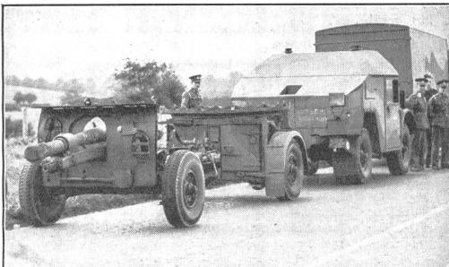
Vorzüglich motorisierte leichte und schwere Artillerie ermöglichen eine rasche Kräftekonzentration gegen besonders gefährdete Punkte. Bild: mot. 8,38-cm-Feldgeschütz (Vickers); Reichweite 9,6 km; Geschossgewicht 8,4 kg; V<sup>o</sup> 505 m/sec.
