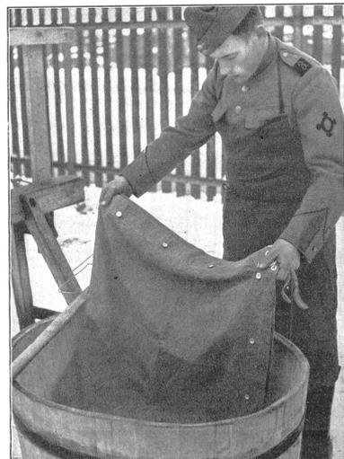
Die zu imprägnierenden Zelte sollen möglichst trocken sein, damit sie sich gleichmäßig mit der Flotte vollsaugen. Sie werden in das Imprägnierungsbad eingelegt und sind 2 Stunden darin zu belassen. (A Ev 0517.)
