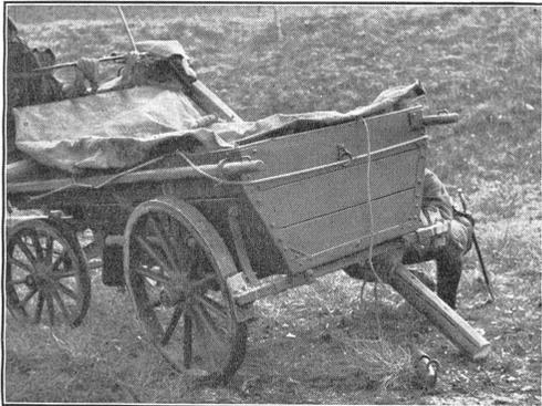
Anfertigung eines Schleifbaumes. Unbrauchbar gewordene Räder sind, wenn Reservräder fehlen, durch Schleifbäume zu ersetzen, die wegen des Rechtsfahrens stets hinten rechts anzubringen sind. (Zensur-Nr. A N 0492.)
