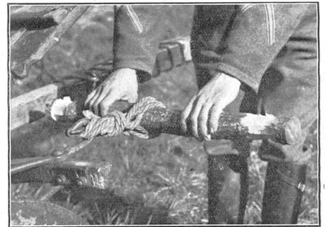
Gebrochene Waagscheite sind durch zu rechtgeschnitzte Holzsparren zu ersetzen, die durch Tragbun an der Waage festgemacht werden. (A N 0484.)
