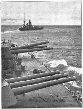
Die Schlachtschiffe sind die großen Hauptkampfschiffe der Flotten; je nach Bauart und Verwendungszweck werden sie in Untergruppen eingefeilt, die Schlachtkreuzer, Panzerschiffe und Linienschiffe. Bewaffnung: 28–35 schwere Geschütze von 10,5 cm bis 40,6 cm Kaliber, von denen die größten in dreibaren Doppel-, Drillings- oder Vierlings-Panzertürmen einge-
