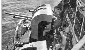
Rechts: Fast alle neueren Schiffsge-schütze vom Kaliber 15,2 cm an ab-wärts sind auch für die Bekämpfung von Luftzielen eingerichtet, wie dies hier aus den Rohreinschnitten des leichten Panzerschildes einer 7,5-cm-Zwillings-Kanone hervorgeht.
