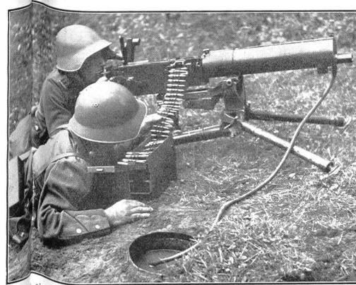
Bei feuchtem Wetter und wenn sich Wasser in der Nähe der Mg.-Stellung, so wird das freie Ende des Dampfschlauches zweckmäßigerweise dort hineingelegt. In vorbereiteten Fällen empfiehlt es sich, zum gleichen Zweck Wasserbehälter (alte Kessel u. dgl.) neben den Mg. einzugraben. (A Er 449.)
