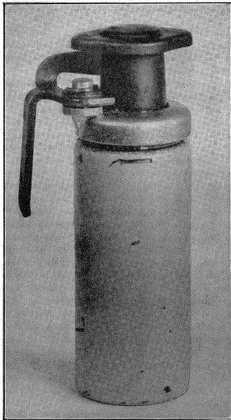
Die schweizerische Offensiv-Handgranate Modell 1917/25 und deren Längsschnitt. (Zensur-Nr. A Er 0221.) La grenade à main offensive suisse, modèle 1917/25, et la coupe en long. La nostra granata a mano offensiva, modello 1917/25 ha un corpo di latta liscio e sottile, dipinto in giallo. Agisce per detonazione e quindi ha un raggio d'azione molto più ristretto della granata difensiva.
