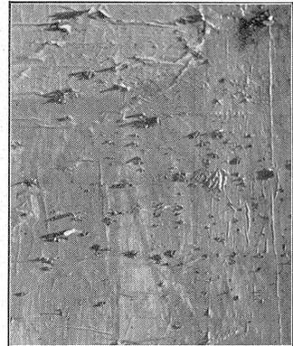
Rechts: Splitterwirkung einer Offensiv-Handgranate Mod. 17/25 auf eine Holzwand in zirka 1 m Distanz. (A N 0132.)
