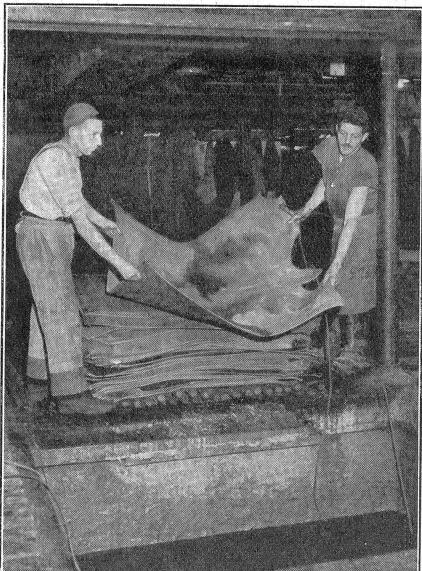
Beim Einlegen von Häuten in eine Grube für Mixtgerbung, welche die Qualitäten der alten Grubengerbung mit den Vorteilen neuzzeitlicher Gerbverfahren verbindet.
