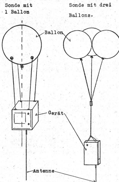
was für Apparate es sich bei den genannten Sonden handelt. Es ist dies ein kleines Meßgerät, das meistens in einem Aluminium- oder Kartongehäuse untergebracht ist und an einem oder mehreren Gummiballons hängt. Die Gummiballons weisen Durchmesser von 80 bis 200 cm auf. Ihre Farbe ist meist weiß oder rot. Am Meßgerät selbst hängt eine Antenne, die je nach der Konstruktion des Gerätes eine Länge von 1 bis 20 oder 30 m aufweist.
