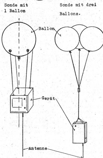
was für Apparate es sich bei den genannten Sonden handelt. Es ist dies ein kleines Meßgerät, das meistens in einem Aluminium- oder Kartongehäuse untergebracht ist und an einem oder mehreren Gummiballons hängt. Die Gummiballons weisen Durchmesser von 80 bis 200 cm auf. Ihre Farbe ist meist weiß oder rot. Am Meßgerät selbst hängt eine Antenne, die je nach der Konstruktion des Gerätes eine Länge von 1 bis 20 oder 30 m aufweist.
