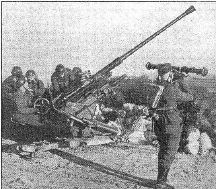
Automatisches 37-mm-Flabgeschütz mit Patronenzufuhr in Metallgurten. Einsatz und Wirkung dürften unserem 34-mm-Flabgeschütz entsprechen.
