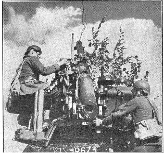
Französisches 7,5-cm-Flabgeschütz, System Schneider, älteres Modell, montiert auf Automobil. Die Bedienungsmannschaft ist mit einem neuen Stahlhelm ausgerüstet, der die Ohren freigibt und damit das Hören erleichtert.
