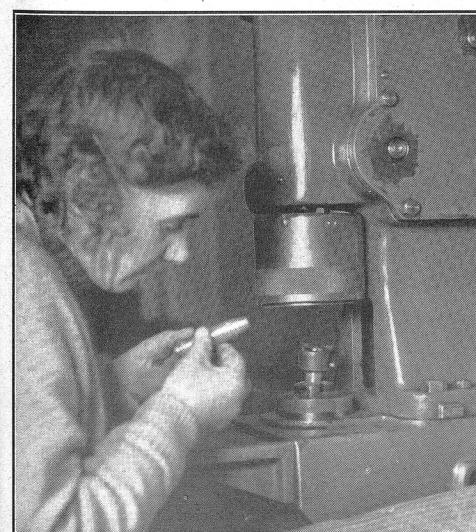
Nachkontrolle des maschinellen auf den Geschoßkörper aufgewindeten Zünders.
