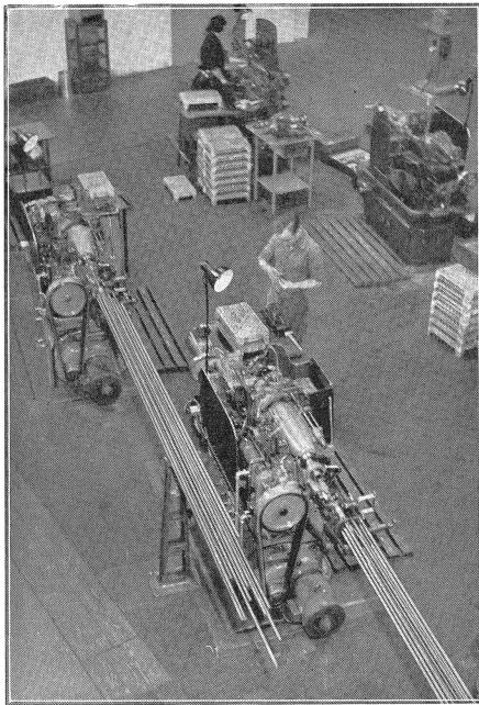
Das Drehen der Geschoßkörper erfolgt aus langen Stahlstangen in den Einspindel-Automaten.
