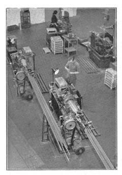
Das Drehen der Geschoßkörper erfolgt aus langen Stahlstangen in den Einspindel-Automaten.
