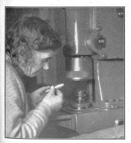
Nachkontrolle des maschinellen auf den Geschoßkörper aufgewindeten Zünders. Contrôle de la fusée vissée dans l'obus.
