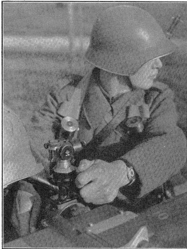
Bild links: Der Hilfsrichter hat die Lage der Schüsse zu beobachten und am Richtgerät die befohlenen Höhen- und Seiten-Korrekturen einzustellen.
