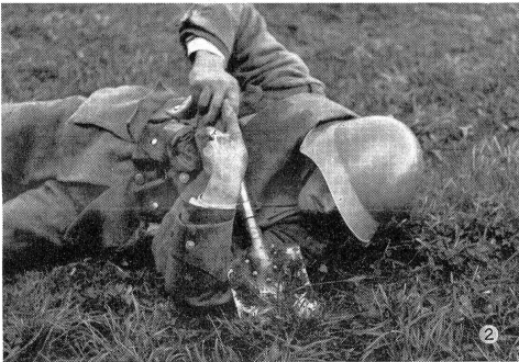
Durch Aufdrehen des Spatenstieles wird Ausnützung des ganzen Spatenblattes erwirkt. Il faut toutefois redresser la bêche pour utiliser toute la surface de l'outil. Facendo leva sul manico, si utilizza tutta la superficie della pala.
