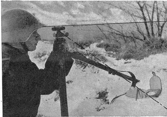
Au goniomètre: Viser le but B avec l'écart latéral: 0040 ‰. Bloquer la base du goniomètre.
