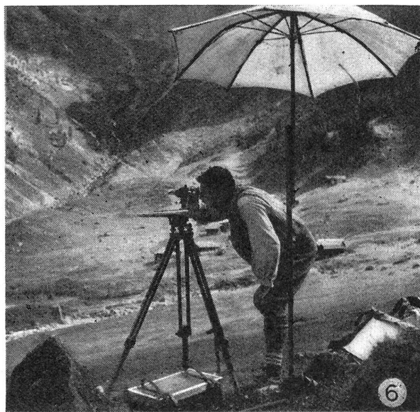
Topographe au travail; complétement à la planchette.
