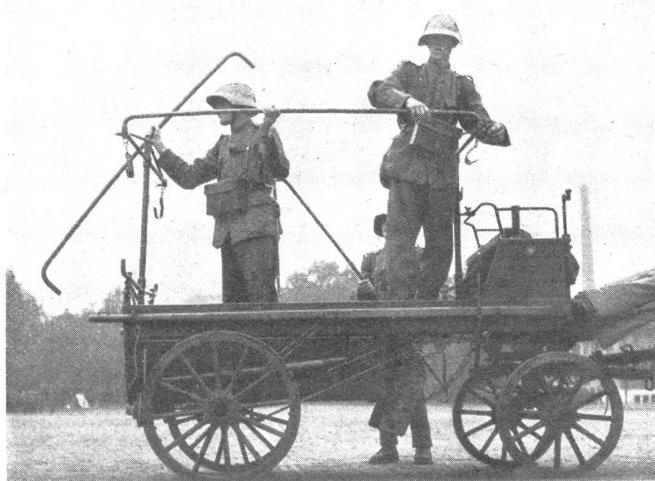
Sanitätssoldaten beim Aufmontieren des Tragbahnen-gestells für Verwundetentransport auf dem Sanitäts-Gebirgsfourgon. Ein ähnliches Ge-stell ist für den Einbau in die den Sanitäts-Kolonnen zugeteilten ge-schlossenen Lieferungswagen angenommen worden.
