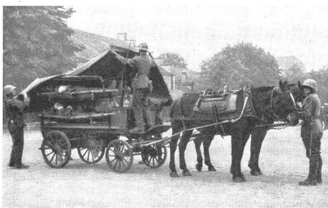
Der bisherige Blessiertenwagen der Sanitätskompanie wird durch einen Gebirgsfourgon ersetzt, auf dem ein abmontierbares Tragbahnen-gestell den Transport von 4 liegenden Verwundeten ermöglicht.
