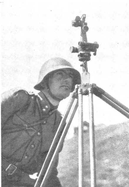
Offizier einer Feldhaubitzbatterie beim Einrichten der Batterie mit dem Batterie-Richtkreis.
