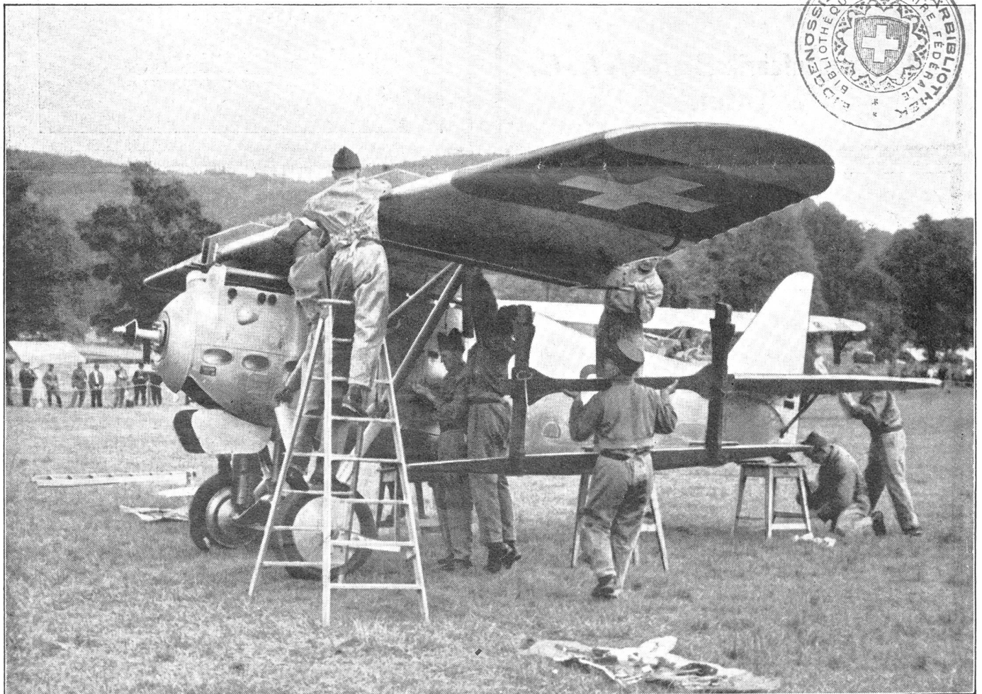
SUT Luzern. Ein Jagdflugzeug wird demontiert. Erste Phase der Demontage. Anbringen der Flügelscheren. Demontage der Steuer. Phot. K. Egli, Zürich. JSSO Lucerne. Démontage d'un avion de chasse. Première phase du démontage. Mise en place des supports d'aile. Démontage des commandes. GSSU a Lucerna. Smontaggio di un apparecchio-caccia. Prima fase dello smontaggio. Rimesso i supporti dell'ala. Smontaggio dei comandi.
