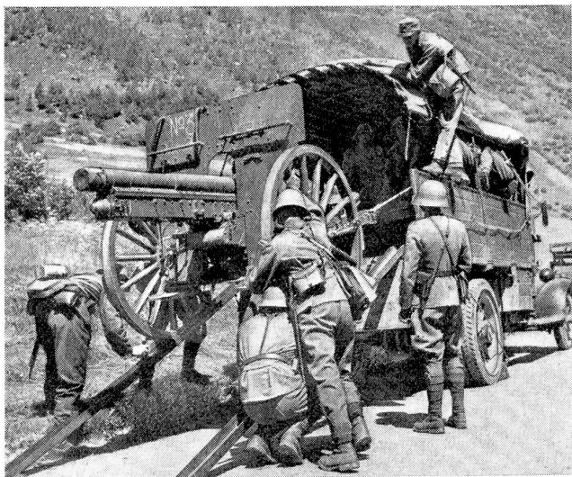
Das Aufziehen der Geschütze in die Transportcamions erfolgt durch Seilzug der auf die Wagen aufgestiegenen Bedienungsmannschaften. Um ein Rückgleiten der Räder auf den Laufschielen zu verhindern, werden Keile unterlegt.
