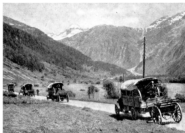
Marschbereite Motor-Kanonen-Batterie. Die Geschützprotzen werden an die Camions angehängt.
