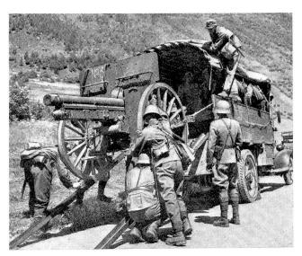
Das Aufziehen der Geschütze in die Transportcamions erfolgt durch Seilzug der auf die Wagen aufgestiegenen Bedienungsmannschaften. Um ein Rückgleiten der Räder auf den Laufschienen zu verhindern, werden Keile unterlegt.
