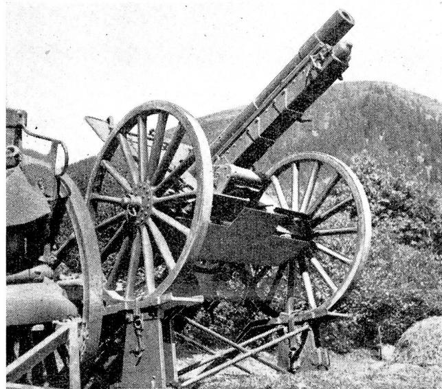
Schußbereites 7,5-cm-Feldgeschütz auf Böcken zur Erreichung der notwendigen größeren Elevation. Die Böcke sind in seitig durch starke Stangen kreuzweise doppelt gegeneinander verstrebzt, was eine große Standsicherheit der Geschütze im Feuer ergibt. Die Geschützräder sind durch starke Flaschenverschlüsse an die obere Tragfläche der Böcke gebunden.
