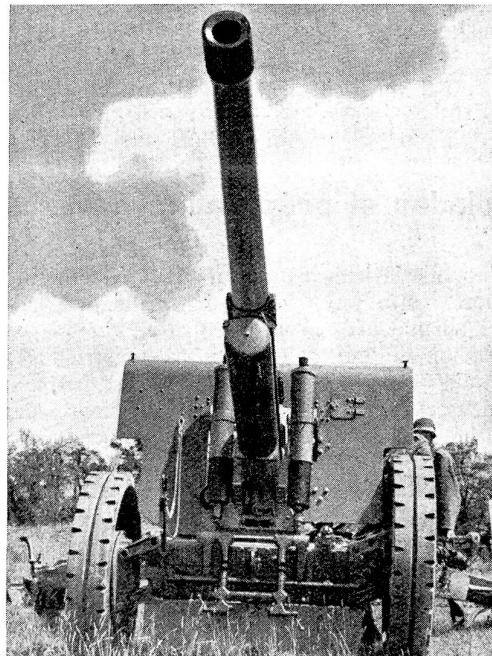
Schubbereite 10,5-cm-Bofors-Kanone in mittlerer Elevation. Mächtig ragt das 4,4 m lange Geschützrohr in die Luft empor. Das Geschütz verfügt über ein Höhenrichtfeld von 800 Promille und über ein Scitenrichtfeld von 1065 Promille. Seine maximale Schußweite beträgt auf eine Höhe von 1000 m ü. M. 18,500 Meter. Vorn am Schutzschild die beiden Gewichtsausgleichsbremsen des Rohres, darunter in der Mitte das umgelegte vordere Marschlager des Rohres.
