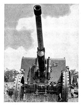
Schußbereite 10,5-cm-Bofors-Kanone in mittlerer Elevation. Mächtig ragt das 4,4 m lange Geschützrohr in die Luft empor. Das Geschütz verfügt über ein Höhenrichtfeld von 800 Promille und über ein Scitenrichtfeld von 1065 Promille. Seine maximale Schußweite beträgt auf eine Höhe von 1000 m ü. M. 18,500 Meter. Vorn am Schutzschild die beiden Gewichtsausgleichsbremsen des Rohres, darunter in der Mitte das umgelegte vordere Marschlager des Rohres.
