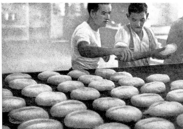
Die Arbeit am Turnusofen. Die Teigbrote werden auf Ofenplatten gelegt, die den Ofen hernach in zirka 70 Minuten durchlaufen und diesen als fertige Brote auf dem laufenden Band verlassen. Die Herdfläche verteilt sich auf 53 bewegliche Platten, die mit je 26 bis 28 Portionen belegt werden konnten. Die Gesamtleistung dieses Turnusofens belief sich auf zirka 1400 Portionen in 70 Minuten.
