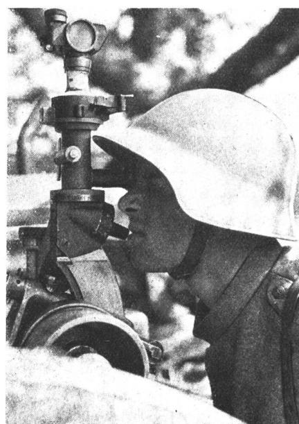
Vom Kommandoposten, der telefonisch mit der Batterie verbunden ist, werden mittels eines Scherenfernrohres die Wirkung des Feuers der eigenen Batterie beobachtet und notwendige Korrekturen durch das Telefon zur Batterie zurückgegeben.
