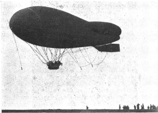
**M 3 startet.** Der Militärballon ist eben als Freiballon mit Motorantrieb gestartet, er besitzt eine Tragfähigkeit von 600 kg (3 Mann Besatzung nebst zugehöriger Ausrüstung) und erreicht eine maximale Geschwindigkeit von 60 km pro Stunde.
