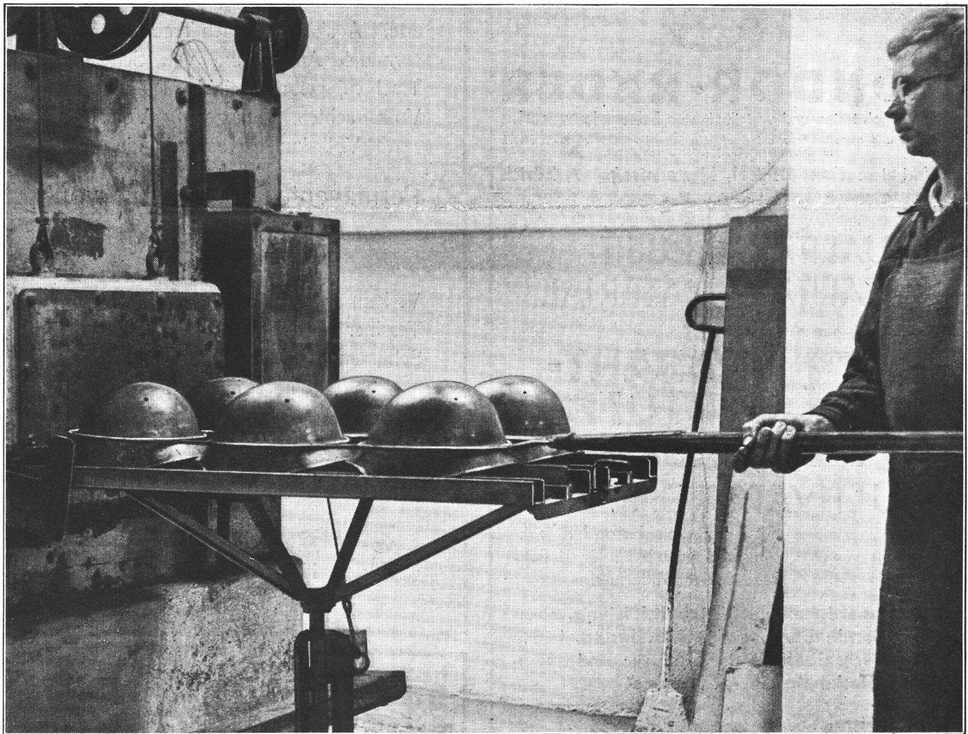
*Von der Fabrikation unserer Stahlhelme. — Aufnahmen aus der Metallwarenfabrik Zug. — Die in ihrer äußern Form fertig erstellten Helme kommen in die Härterei, in welcher sie wiederum während 5 Minuten unter einer Hitze von 830° gehärtet werden. Im Härteofen haben immer 6 Helme gleichzeitig Platz.*
