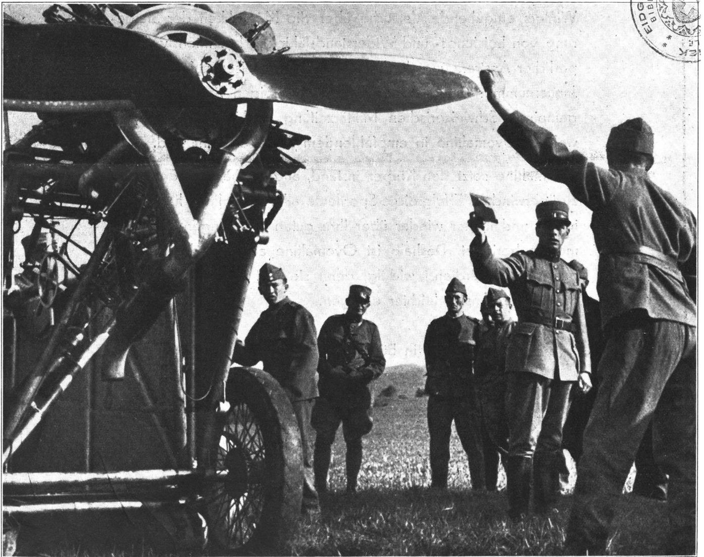
*M 3 startet.* Bei der Arbeitseinteilung des Gondeltrupps. Die Motorgondel ist mit einem Benzinmotor mit 100 PS. Leistungsfähigkeit ausgerüstet, der Benzinvorrat reicht für einen Flug von 4 Stunden aus. Das Radgestell dient lediglich für einen leichtern Transport der Gondel am Boden, vor dem Fluge wird es abmontiert.
