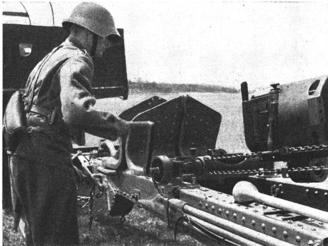
Ebenfalls während des Marsches ist das 4,4 m lange Geschützrohr auf ein hinteres Marschlager zurückgezogen, in das die Winde eingebaut ist, mit welcher das Rohr dann mittels einer Kette in die Schußstellung vorgewunden wird. Die Verbindung des Rohres mit der Preßluftvorholung erfolgt durch eine starke Schraube, deren Führungskanal im Bilde noch rechts unter dem Verschluß sichtbar ist. Hinten auf der Lafette sind während des Marsches die zwei je 50 kg schweren Lafetten-Sporne befestigt.
