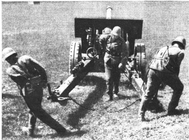
Die 10,5-cm-Bofors-Kanone ist mit einer zweiteiligen Spreizenlafette versehen, die, während des Marsches zusammengeschlossen, beim Stellungsbezug geöffnet wird. Dabei ist es nicht notwendig, daß beide Spreizenenden auf dem gleichen Bodenniveau ruhen. Eine sinnreiche pneumatische Vorrichtung in der Lagerung der Lafette ermöglicht ohne weiteres den Ausgleich allfälliger Niveaudifferenz.
