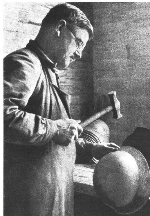
Nun gelangen die Helme in die Spenglerei, wo die durch die verschiedenen « Züge » entstandenen Übergangsstellen von Hand eingehämmert werden.
