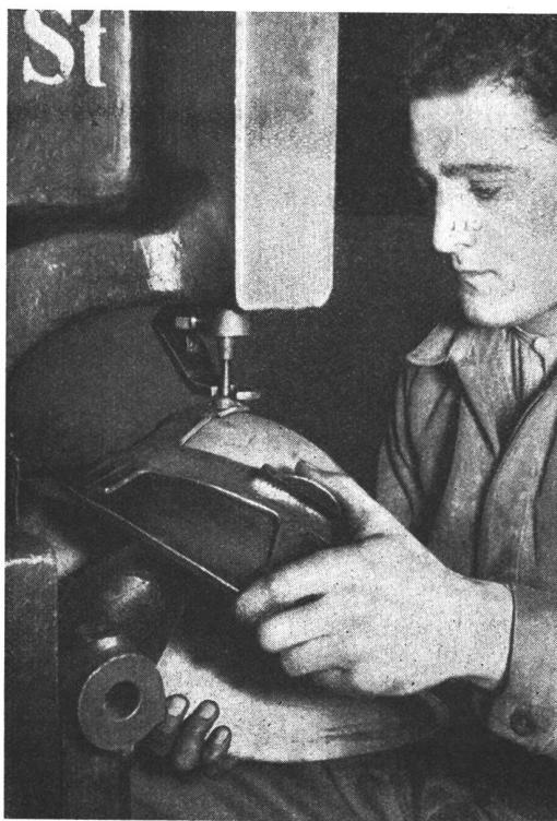
Nach vollendetem Ziehen der Helme werden in erster Linie die Ventilationslöcher eingebohrt, wobei eine spezielle Schablone über den Helm gestülpt wird.
