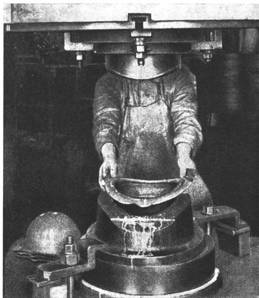
In 6 verschiedenen « Zügen » (Druckvorgängen) erhält das Stahlblech nach und nach die Form des Helmes. Dieses Ziehen des Materials erfolgt unter hydraulischen Pressen, die zum Teil einen Druck von über 100 Tonnen besitzen.
