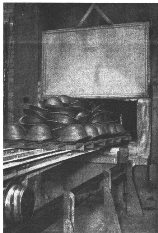
Zwischen dem 5. und 6. Zug werden die Helme in einem elektrischen Ofen bei über 800° ausgeglüht. Mittels eines Rollschlittens werden dabei Partien von 30 bis 40 Stück auf einem Gestell in den Ofen gebracht. Unser Bild zeigt den Augenblick, in welchem die ausgeglühten Helme aus dem Ofen gezogen werden.
