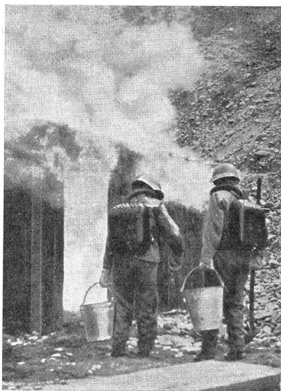
Passiver Luftschutz. Versuche mit Brandbomben. Die Löschmannschaft dringt, mit dem Sauerstoffgerät ausgerüstet, zum Brandherd vor und löscht diesen durch Ersticken mit Sand.
