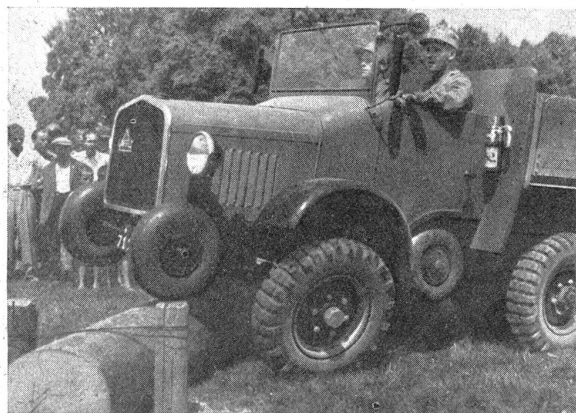
Mannschaftstransportwagen französischen Ursprunges mit einer speziellen Räderkonstruktion zum Überwinden von Hindernissen.
