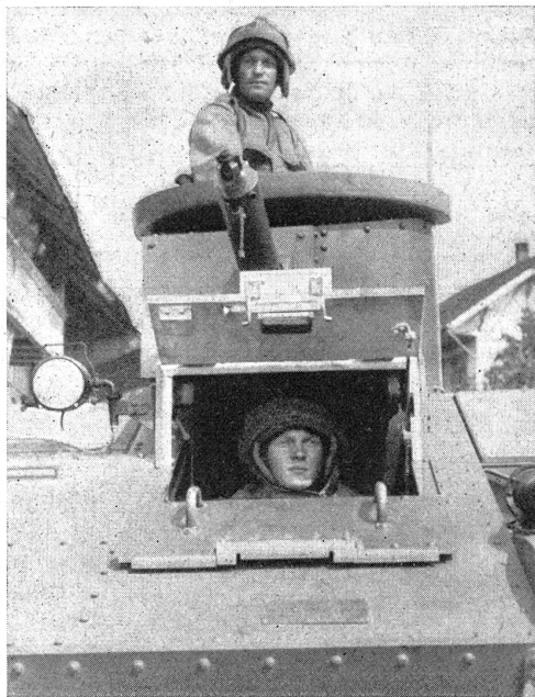
Die Besatzung eines Panzerwagens während eines Vormarsches an den Gegner. Aussichtsklappe des Führers und Panzerturm des Schießenden sind noch geöffnet, an der Aussichtsklappe (unten) ist deutlich die Dicke der Panzerplatten (13 mm) erkennbar.
