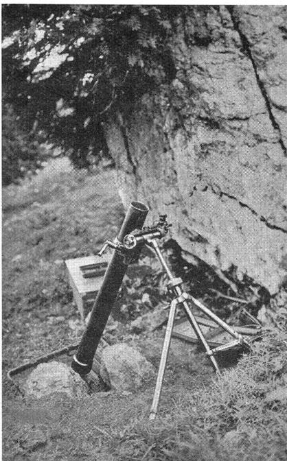
Fig. 6. Le mortier Stokes-Brandt de 81 mm, modèle 1930.
