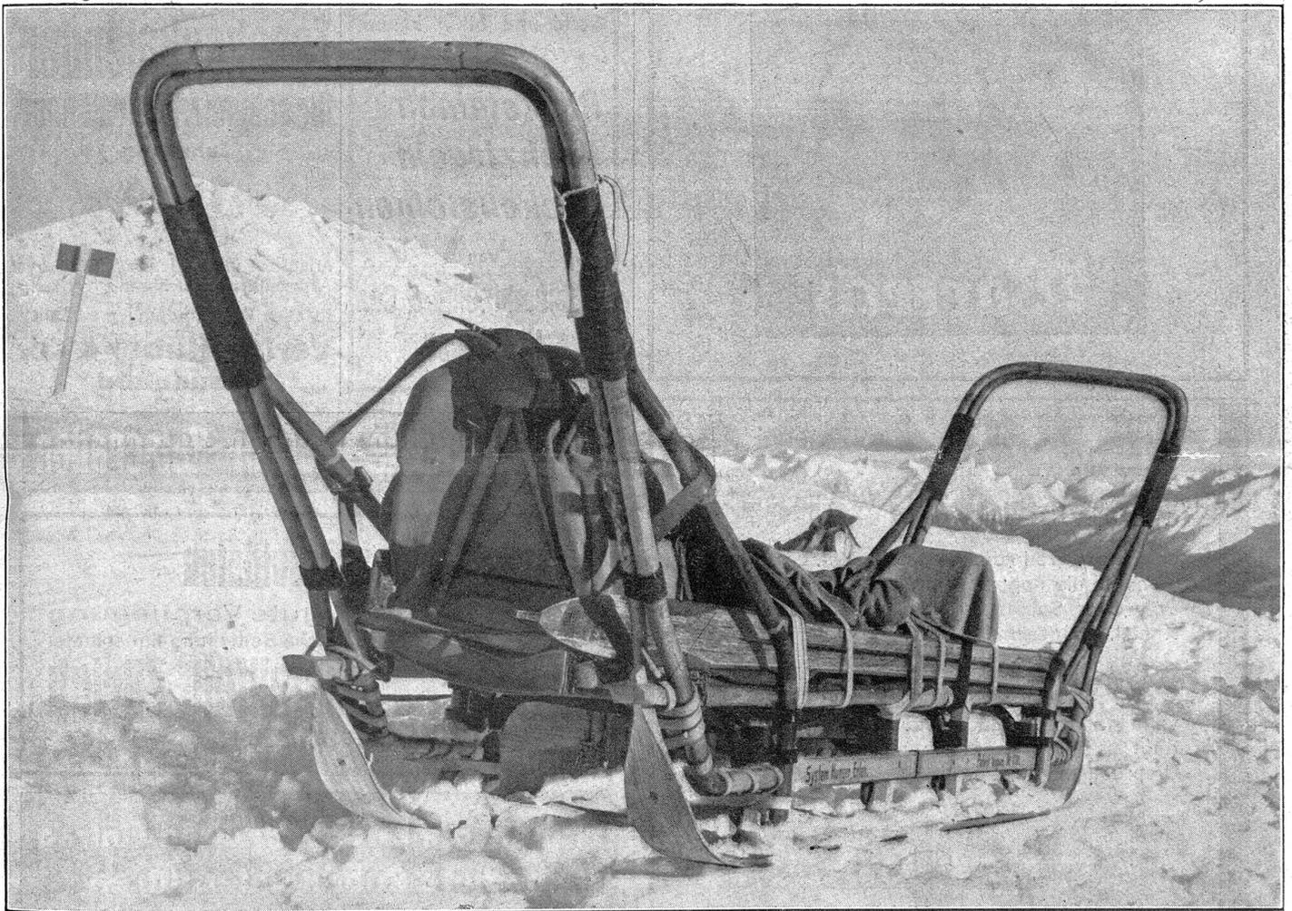
Bild 1. Der Schweiz. Hungerschlitten Modell 1934 montiert und beladen. Die Skis des Transportierten sind als Seitenteile montiert, sein Rucksack (Tornister) dient als Kopfschutz, er selbst liegt in zwei Hüllen verpackt, innen Wolldecke, außen Segeltuch. Den Transportierenden stehen als Haltevorrichtung zwei abnehmbare Bügel zur Verfügung (Etageschlitten, Zweibügelssystem). Beinbrüche werden prinzipiell kopfabwärts transportiert.
