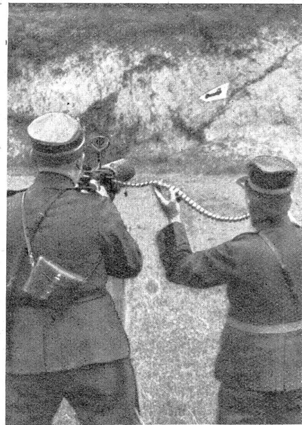
Bild 5. Schießen auf bewegliche Flugzeugziele auf dem Schießplatz Wallenstadt. Mittels eines Haspels wird die Flugzeugscheibe mit beträchtlicher Geschwindigkeit auf eine Distanz von über 100 m vor dem Maschinengewehr vorbeigezogen. Der Schiessende visiert nach dem bei Bild 4 angeführten System das Ziel an und feuert, ohne jedoch dem Flugzeug mit der Visierlinie zu folgen. Gleich die erste Schießübung ergab ein Resultat von vier Treffern im schwarzen Flugzeug selbst und sieben Treffer im weißen Teil der Scheibe.
