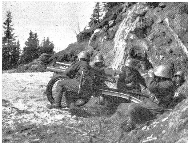
Die Infanteriekanone im Augenblick des Abschusses. Deutlich ist die Wirkung des Rohrrücklaufes sichtbar.
