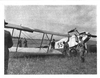
Zweites Tragflächenpaar wird ausgehoben. Démontage de la deuxième paire d'ailes.
