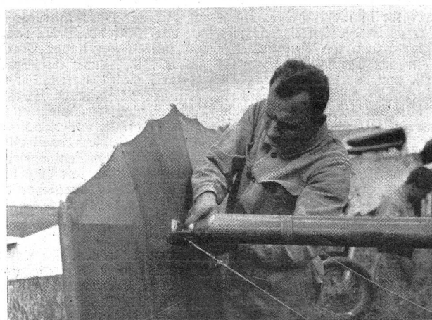
Vollständige Demontage eines Tragflächenpaares. Phot. Carl Jost, Bern Démontage complet d'une paire d'ailes.
