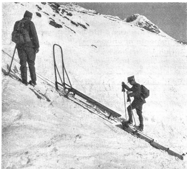
Bild 2. Die zwei Grundtypen der Rettungsschlitten im Aufstieg, vorn Etageschlitten, hinten Parterreschlitten
