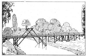
Hängewerk-Kolonnenbrücke über die kleine Aare bei Brugg, mit einseitig flachem Ufer. Ausgeführt von der Rekrutenschule für Nachgemusterte im Jahre 1916.
