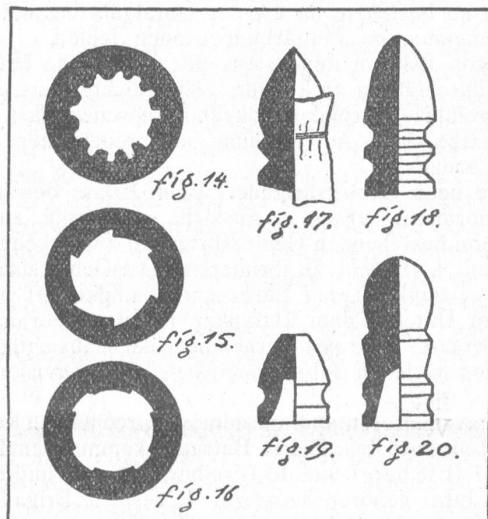
schoss) aus einem glatten Rohr abgefeuert, so stellt es sich bald mit seiner Längaxe quer zur Schussrichtung, es nimmt die Lage ein, in der sein Schwerpunkt am weitesten vorne liegt. Soll das Projektil mit seiner Axe in der Schussrichtung bleiben, so müssen wir es um dieselbe rotieren lassen. Wir haben hier die gleiche Erscheinung wie beim Kreisel (den wir aus unserer Jugendzeit kennen), der auf der Spitze stehen kann, so lange er sich dreht.
