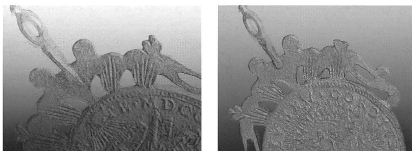
Fig. 21 Nuvole di punti da rilievo con scanner laser del campione 456; l'enfatizzazione del particolare dell'innesto dell'appiccagnolo sulla montatura è ottenuta grazie alla possibilità di cambiare la direzione dell'illuminazione.
