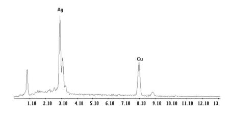
Fig. 11 Spettro montatura abrasa, punto 3 nella campionatura.
