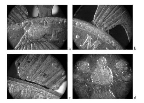
Fig. 4 Campione 458. Immagini allo stereo microscopio del foro riempito (a), della lega di brasatura che unisce montatura e moneta (b), della parte in cui la montatura non è ben saldata alla moneta (c), della colomba con i graffi da usura (d).
