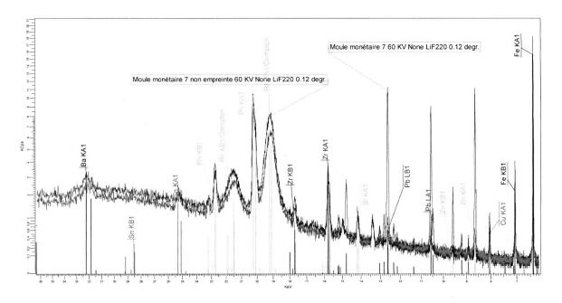
Fig. 11 Spectres obtenus par fluorescence X sur les moules M6 et M7; comparatif des faces empreinte (M 6/7) et non empreinte (M 6/7 non empreinte) (analyses CEA Le Ripault).
