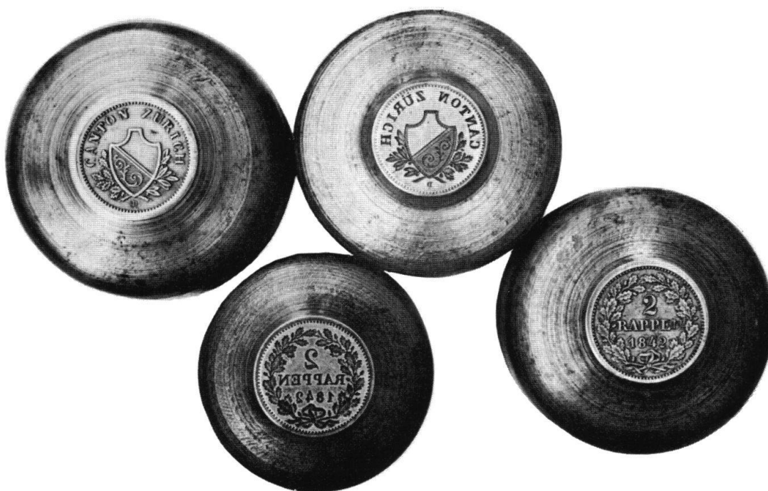
Abb. 1 Die erhaltenen Werkzeuge der Zürcher 2-Rappen-Prägung des Jahres 1842 (jeweils von links nach rechts, obere Reihe: V 1, V 2, untere Reihe: R 2, R 1).
