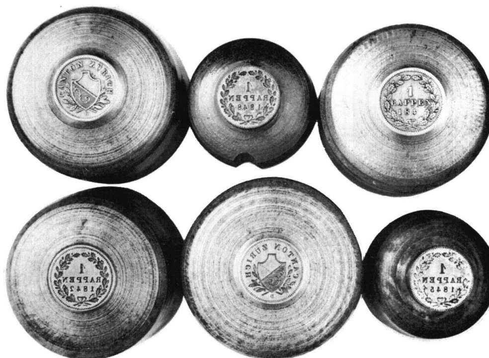
Abb. 2 Die erhaltenen Werkzeuge der Zürcher 1-Rappen-Prägung der Jahre 1842-1848 (jeweils von links nach rechts, obere Reihe: V 3, R 6, R 3, untere Reihe: R 4, V 4, R 5).
