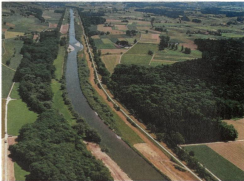
Die Thur bei Niederneunforn-Altikon TG vor der Sanierung im Jahr 2000: Der Fluss ist begradigt, liegt in einem künstlichen Schotterbett und die Ufer sind mit mächtigen Steinblöcken verbaut. Der Auenwald auf der rechten Flussseite ist vom fliessenden Wasser getrennt (Blickrichtung flussabwärts).
