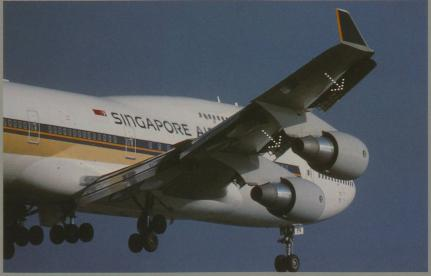
Die zur Landung ausgefahrenen Vorflügel- oder Nasenklappen entsprechen dem Daumenfittich der Vögel. Vögel werden alt. Deshalb brauchen sie mehrmals ein neues Gefieder. Um immer fliegen zu können, werden die Flügelfedern nach einem abgestuften Programm erneuert. Nur wenige Vögel wie Enten, Gänse und Rallen sind während des Gefiederwechsels (Mauser) eine Zeit lang flugunfähig.
