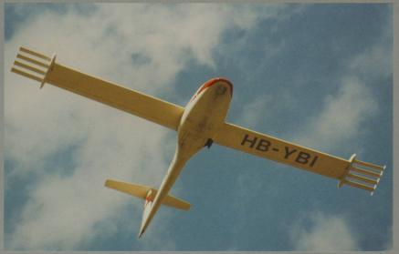
Der Natur abgeschaut! Fingerförmige Flügelspitzen, so genannte Winggrids, ermöglichen den Bau von Flugzeugen mit geringerer Spannweite, Luftwiderstand und Treibstoffverbrauch.
