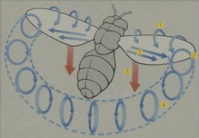
Die beim Flügelabschlag eines schwebenden Insekts auftretenden Luftwirbel, wie sie an der «Robofly» beobachtet wurden.
