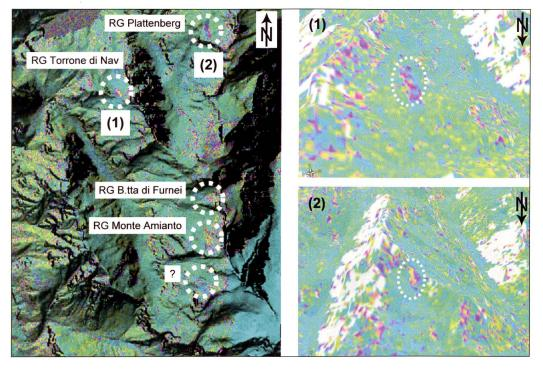
Figura 2.35 — Interferogramma InSAR ALOS a 46 giorni di intervallo (tra il 13.09.2006 e il 29.10.2006) della Val di Carassino, presentante diversi rock glaciers attivi. Fonte delle immagini: STROZZI et al. (2007).
